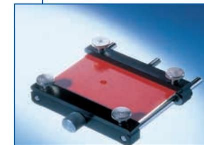
FSC 80 Фиксатор тонких плёнок
