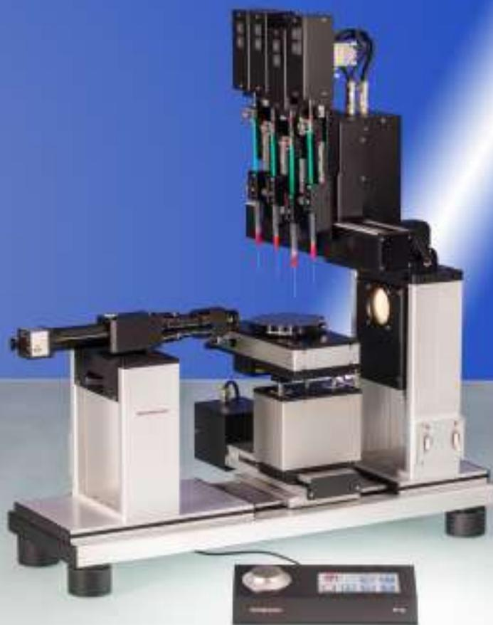
OCA 50 с четырьмя модулями прямого дозирования DDE/4 и поворотным столиком ETT
