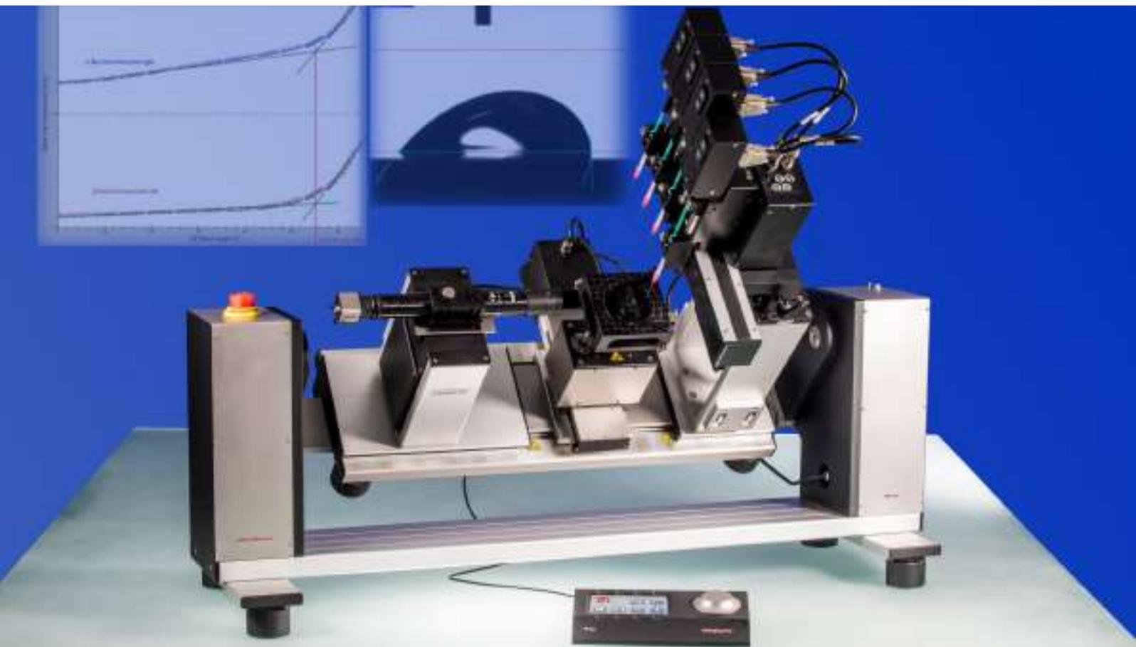
OSA 200 с четырьмя модулями прямого дозирования DDE/4 и наклонным модулем TBU 100
