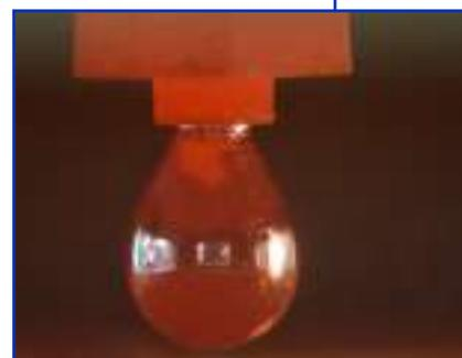
Капля расплавленного алюминия
