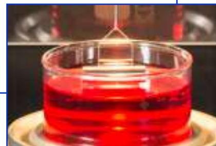
Определение плотности жидкости с DIS 11
