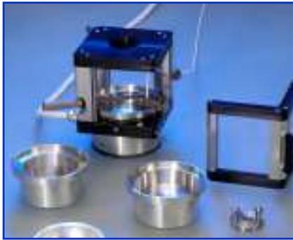
Термоячейка TEC 250/DCAT для работы при 250°C
