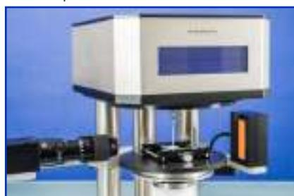
Исследование адгезии с модулем UpVideo DCAT
